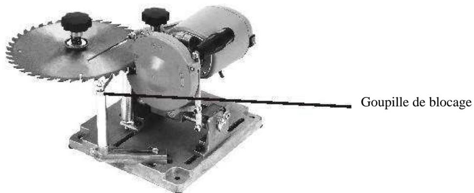
Allumez la machine pour lancer le processus d'affûtage et activez le levier pour déplacer la meule vers la dent jusqu'à ce qu'elle atteigne la jauge de profondeur ajustée.
