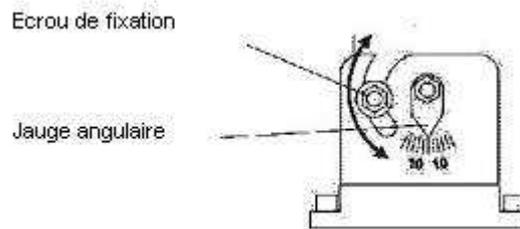
Il se peut que l'angle souhaité ne puisse être ajusté car le moteur touche l'embase pour de grands angles. Dans ce cas, tournez le bloc moteur de 180° dans la butée du porte-moteur (desserrez la vis de blocage sur le collet du moteur).
