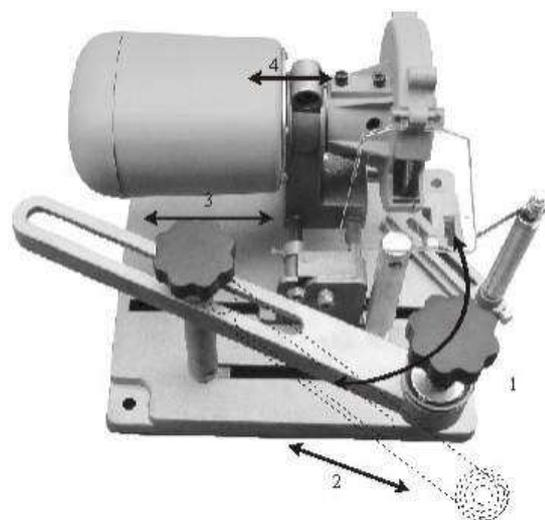
Par le biais de ces possibilités d'ajustement, vous pouvez toujours mettre votre lame de scie dans la bonne position par rapport à la meule. Lors du meulage, la meule se déplacera d'avant en arrière par le biais du levier de commande. Le levier doit être levé pour régler la position correcte, pour que la meule puisse se bloquer au fond de la dent.
