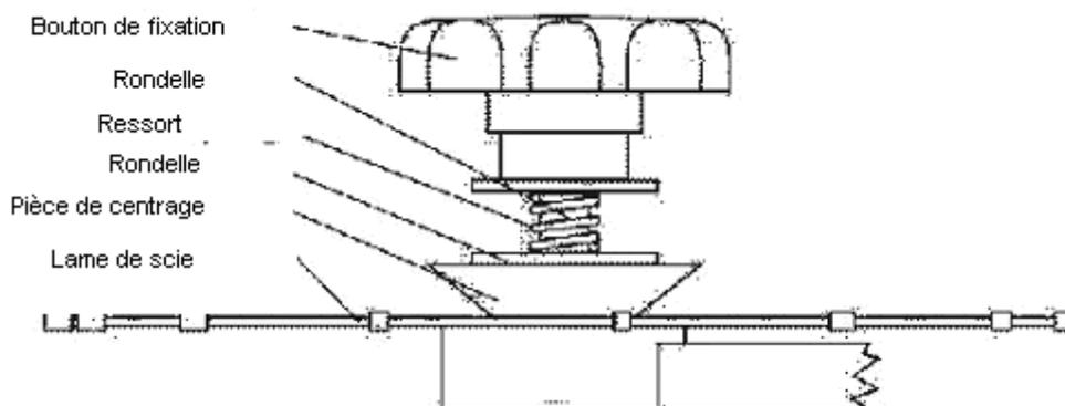
La lame de la scie doit être simplement centrée mais non serrée, ne serrez le bouton de fixation que dans la mesure du nécessaire pour assurer une tension suffisante de façon à ce que la lame de la scie puisse encore être tournée. Assurez-vous que la pièce de centrage n'est pas inclinée.
